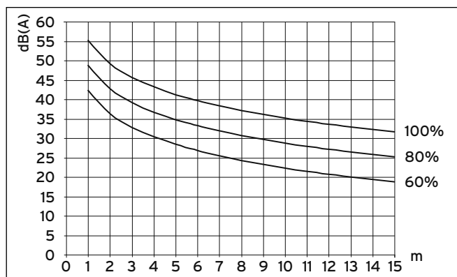
Мал. 6.4 Рівень звукового тиску двох зовнішніх модулів в дБ(А) залежно від віддаленості й числа оборотів вентилятора для VWL 141/3 S при установці у вільному звуковому полі
