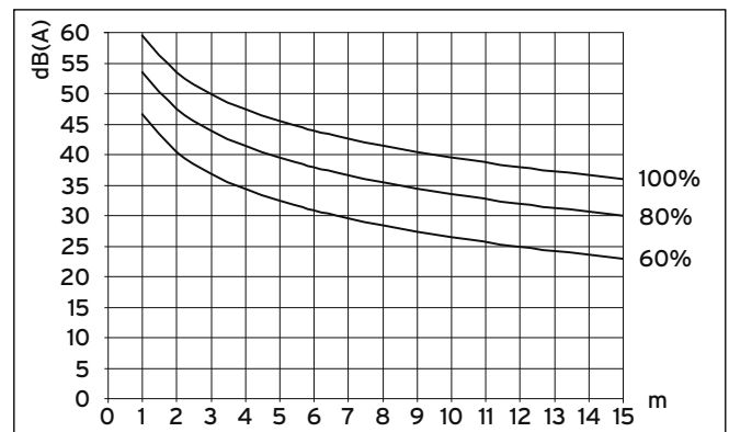
Мал. 6.3 Рівень звукового тиску зовнішнього модуля в дБ(A) залежно від віддаленості й числа оборотів вентилятора для VWL 101/3 S при установці у вільному звуковому полі
